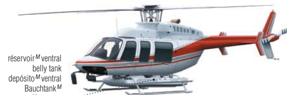
hélicoptère M bombardier M d'eau F water bomber helicopter helicóptero M contraincendios Löschhubschrauber M elicottero M antincendio
